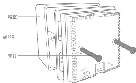
4 根据图示方向固定壳盖，完成安装。
